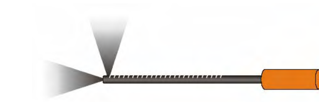
図33:せん孔プローブの走査域
