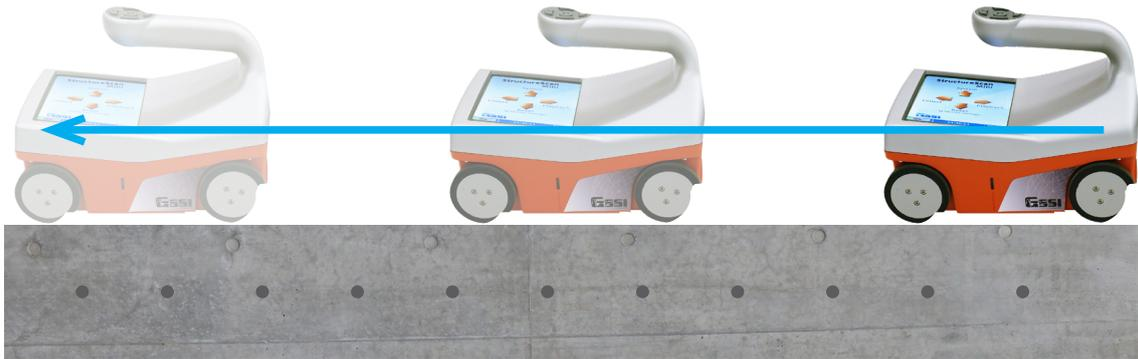
4. 測定中、本機を後退させると測定データ画面上に縦線(バックカーソル)が表示されます。バックカーソル位置は本機から照射されている赤色のレーザー光の位置と一致します。バックカーソルを山形波形の頂点に合わせた時、本機アンテナの中心(上下レーザー光位置)とターゲットの位置が一致します。
