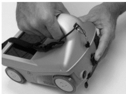
4. バッテリーをスロットに挿入し、取り外しクリップに固定します。
