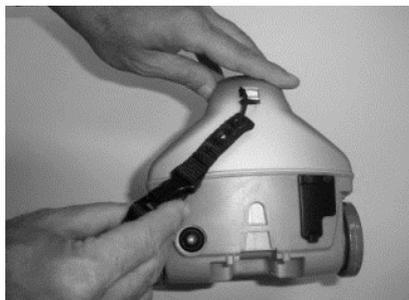
3. バッテリーストラップがある場合は取り付けてください。探査中のバッテリー落下防止になります。
