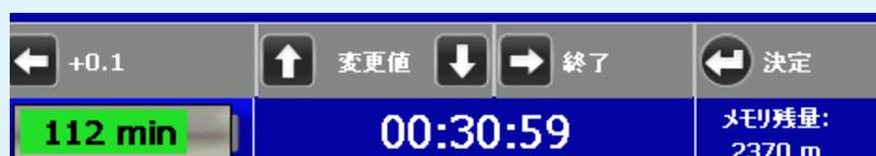
※正確に比誘電率を設定すると、深度についてより高精度の探査につながります。
