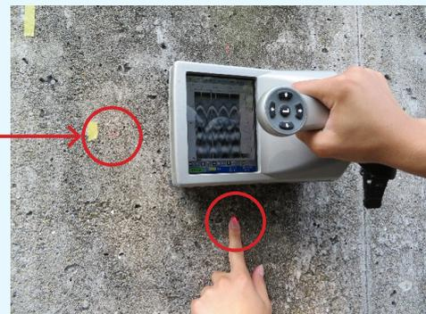
(4) さらにレーダ装置を前部レーザー光の位置が指等でマークした位置と直交する位置まで後退させ、その前部レーザー光位置にチョーク等でマークする。
