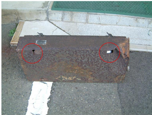
落下照明背面状況
