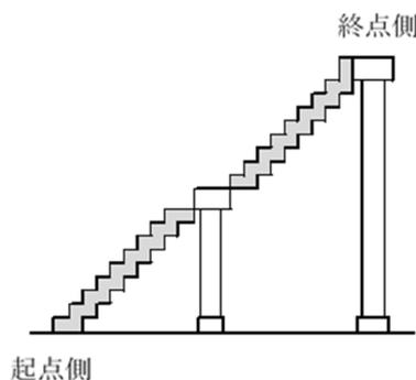
付図－1. 2. 2 階段部の起終点の考え方
