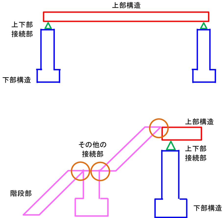
付図－1. 4. 1 構成要素の構成（捉え方）の例
