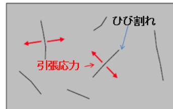
図 19-2 引張応力とひびわれの方向
