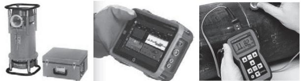
工業X線発生装置 超音波探傷器 USM100 超音波厚さ計 DM5E
