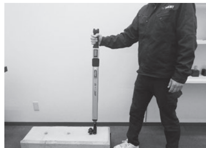
図3 アンカーボルト引張荷重検査機器例 試験機：APC-10B APC-05B
