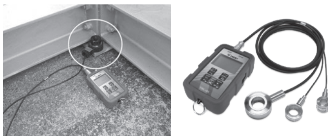
図2 レンチ加圧式試験および試験機の例 試験機：TR-20F TR-75F TR-150F
