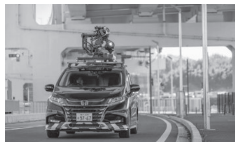
写真1 走行型赤外線調査車両外観
